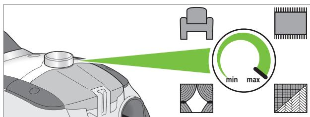
El regulador de potencia puede regularse de forma gradual. La posición del regulador de potencia debe adaptarse a la superficie aspirada:
