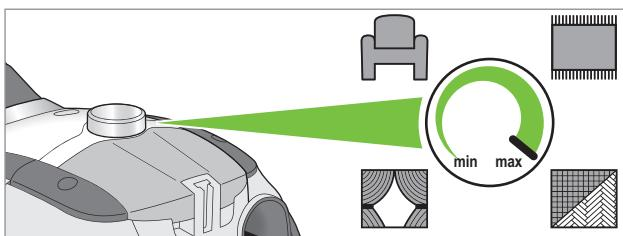
Der Leistungsregler ist stufenlos verstellbar. Je nach zu saugendem Untergrund sollte die Stellung des Leistungsreglers angepasst werden:
