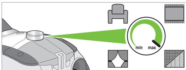
De vermogensregelaar is traploos verstelbaar. Afhankelijk van de te zuigen ondergrond moet de stand van de vermogensregelaar aangepast worden:
