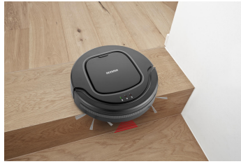
Treppenstufenerkennung durch moderne Sensortechnik.
