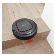
intelligent: Treppenstufenerkennung durch moderne Sensortechnik.
