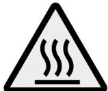
Les surfaces du boîtier, l'élément chauffant et les accessoires sont chauds pendant et après l'utilisation.
