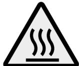
Kotelon pinnat, lämmityselementti ja muut lisävarusteet ovat kuumia käytön aikana ja sen jälkeen.
