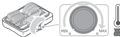
Para manter quente, posicionar o controlador entre "MIN" e "MAX".
