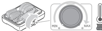
Lämpimänä pitoa varten aseta säädin asentojen "MIN" ja "MAX" väliin.
