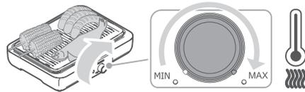
Zum Warmhalten den Regler zwischen „MIN“ und „MAX“ positionieren.
